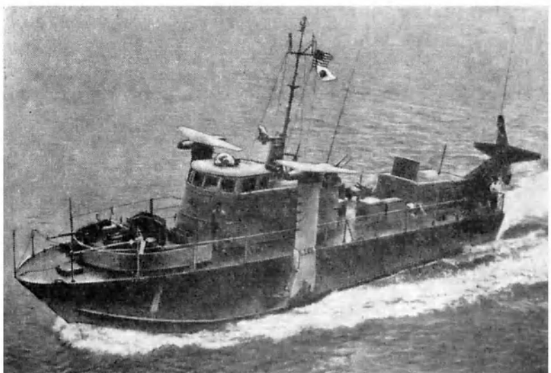
Рис. 5. Корабль на подводных крыльях США «Флагстаф» в водоизмещающем положении с поднятыми крыльями.
