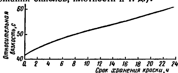
Рис. 2. Изменение относительной вязкости цинксиликатной краски на цинковом порошке ПЦ-2 в течение суток.
